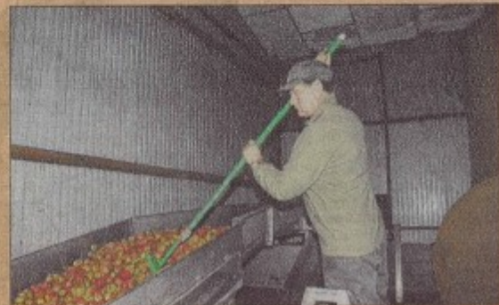
Le système de circulation hydraulique des pommes aboutit ici. Dernière étape, et dernier contrôle qualité, avant le râpage, puis le pressage...
